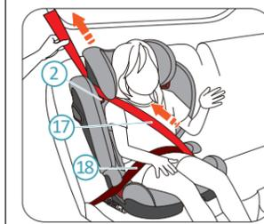
**危险** 检查肩带部分 ⑰ 和腰带部分 ⑱ 都应该固定在底座上的臀部安全带导向槽 ⑥ 中。
