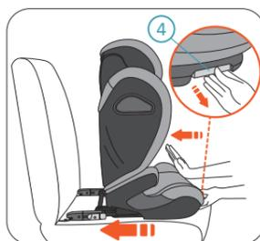
4. 用一只手拉住FIX调整把手 ④, 用另一只手将儿童座椅尽可能推向汽车座位, 直到儿童座椅稳稳地靠在汽车座位的靠背上。松开FIX调整把手, 儿童座椅安装完成。
