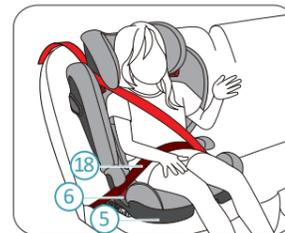
3. 将底座 ⑤ 另外一侧的腰带部分 ⑱ 也固定在臀部安全带导向槽 ⑥ 中。
