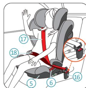
2. 将卡扣 ⑯ 一侧的肩带部分 ⑰ 和腰带部分 ⑱ 固定在底座 ⑤ 上的臀部安全带导向槽 ⑥ 中。
