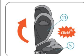
2. 将靠背 ⑪ 向上旋转扶起, 直到随着响声在直立位置固定
