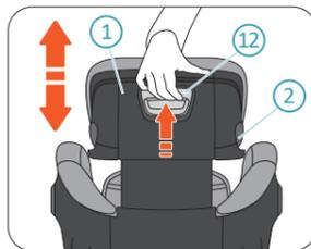
拉住头枕背后的头枕调节把手 ⑫ 以解锁头枕 ①。将头枕移动到合适位置, 让头枕 ① 刚好在孩子肩膀上方(约1手指距离)。然后松开头枕调节把手, 锁定头枕高度。
