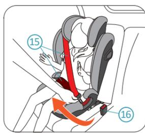
按下卡扣上的红色按钮解锁3点式安全带 ⑮, 然后将3点式安全带从卡扣 ⑯ 一侧拉到另一边, 儿童座椅对儿童的固定就解除了。
